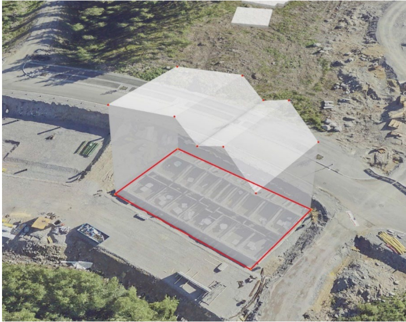
Kuva 20. Mittausten pohjalta luotu rakennuksen 3D-malli.
